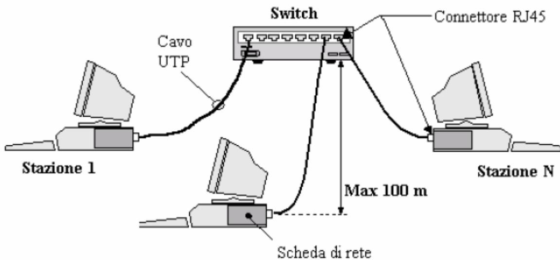
Si può, quindi, proporre di installare uno switch in ciascuno dei locali da cablare; gli switch possono essere poi collegati ad uno switch principale che deve avere caratteristiche tecniche più evolute.
