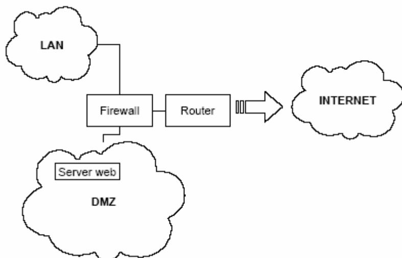
Per questioni di affidabilità è necessario che il firewall sia una macchina con sistemi di tolleranza ai guasti, in particolare è possibile indicare un sistema di ridondanza dell'alimentazione elettrica (doppio alimentatore), nonché un sistema di ridondanza delle memorie di massa (RAID).
