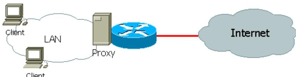
In pratica si ha la stessa situazione dello scenario precedente, solo che viene utilizzato un server Proxy per permettere l'accesso sicuro, protetto e regolamentato verso Internet.
