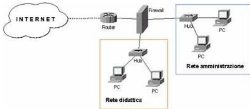
In questo caso un PC con software Open Source opportunamente configurato e tre schede di rete svolgono efficacemente la funzione di firewall.
