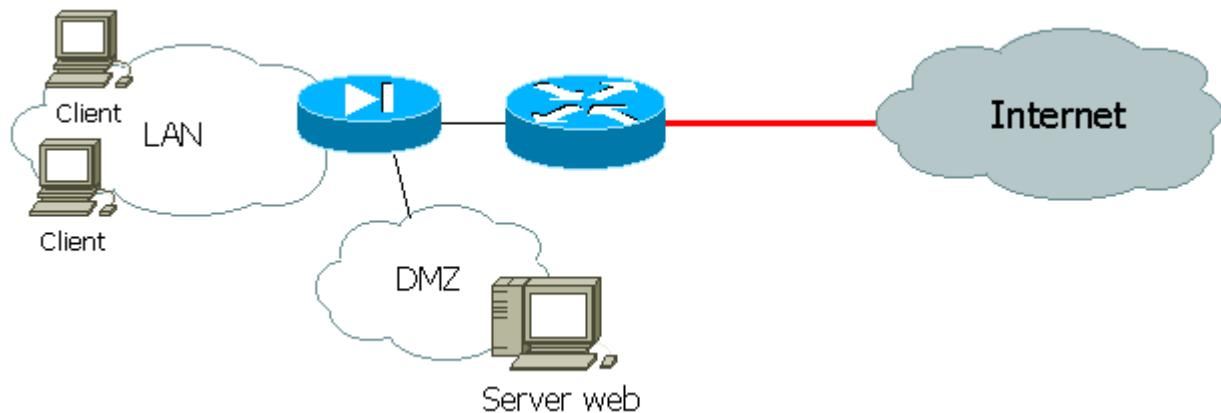
Si può osservare una suddivisione della rete locale in diverse componenti: la rete interna e la zona DMZ. L'accesso ad Internet è garantito da un router ed è protetto da un firewall. In tale situazione rientrano anche le realtà ancora più complesse che prevedono una serie di uffici distaccati con le proprie reti locali e che fanno riferimento ad un unico router di raccolta.
